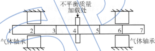
图 3 径向气体轴承 转子系统模型
